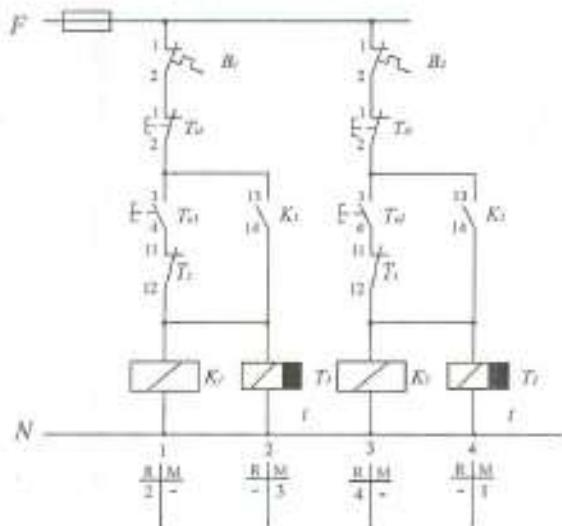
32. Na slici je data tropolna šema puštanja u rad trifaznog asinhronog motora sa kratkospojenim rotorom primenom "upuštača" zvezda – trougao. Potrebno je izraditi upravljačku šemu koja će omogućiti da po pritisku na taster za uključenje motor počne da radi sa statorom vezanim u zvezdu, da bi posle 3 minuta "prešao" na trajan rad sa statorom vezanim u trougao. Motor se isključuje pritiskom na taster za isključenje.
