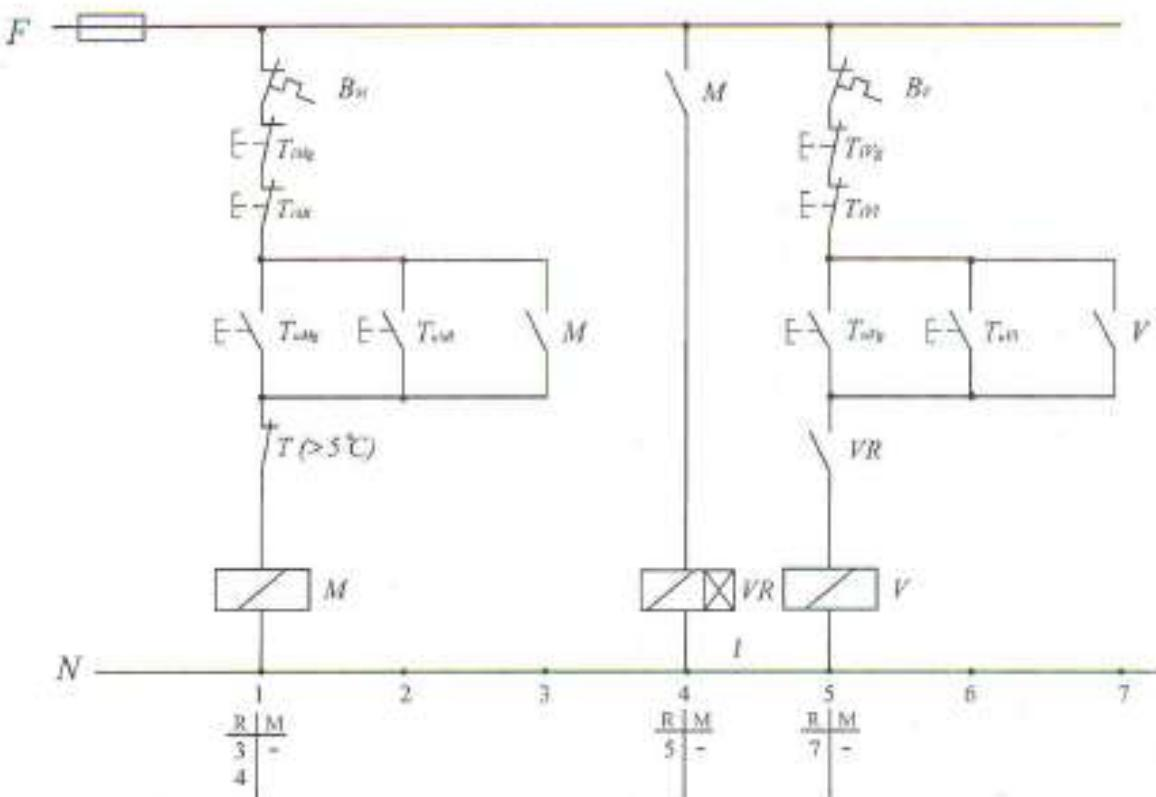
39. Rezervoar vode, korisne visine 3m, puni se pomoću pumpe koju pokreće trofazni asinhroni motor sa kratkospojenim rotorom. U rezervoaru su postavljena dva plovka – prvi na visini 1.5m i drugi na visini 2.5m. Treba izraditi upravljačku šemu koja će omogućiti ispunjenje sledećih zahteva:
