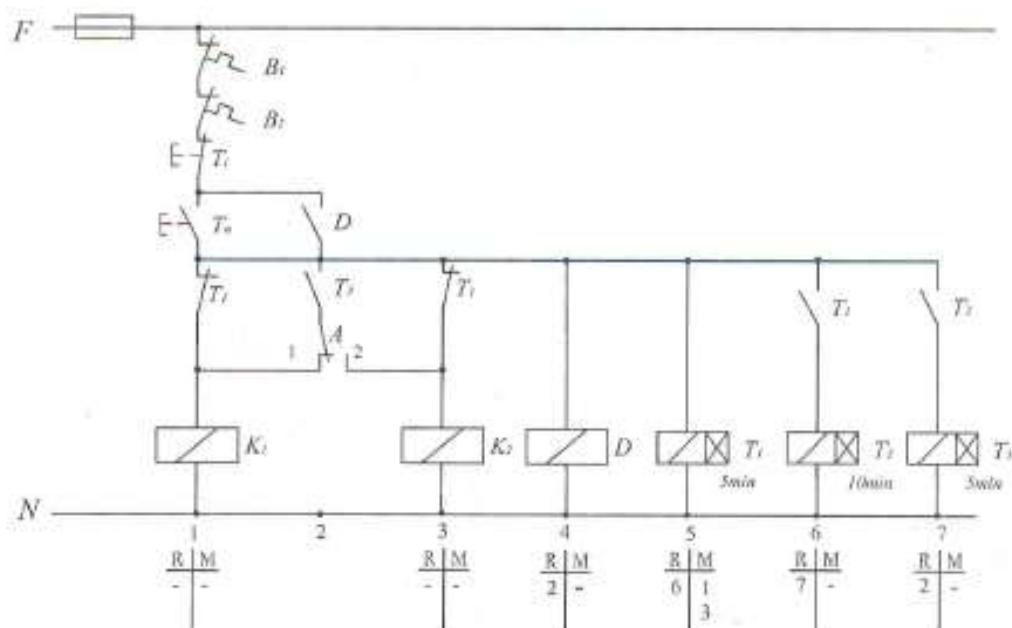
42. Izraditi upravljačku šemu za rad motora lifta, koji povezuje samo prizemlje i prvi sprat zgrade. Postoje sledeći granični kontakti:
