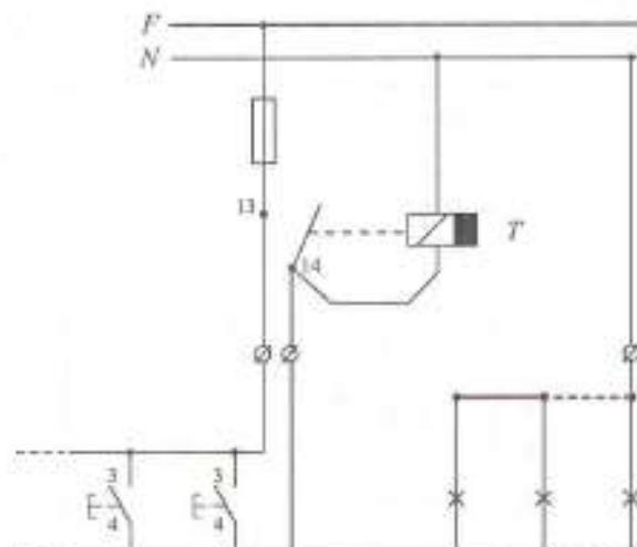
Za veće zgrade, sa strujom u strujnom kolu stepenišnog osvetljenja većom od  $6A$ , pored vremenskog releja mora se upotrebiti i prekidač sa elektromagnetom, čiji glavni kontakt može da podnesu tu veću struju. U tom slučaju šema delovanja ima sledeći izgled:
