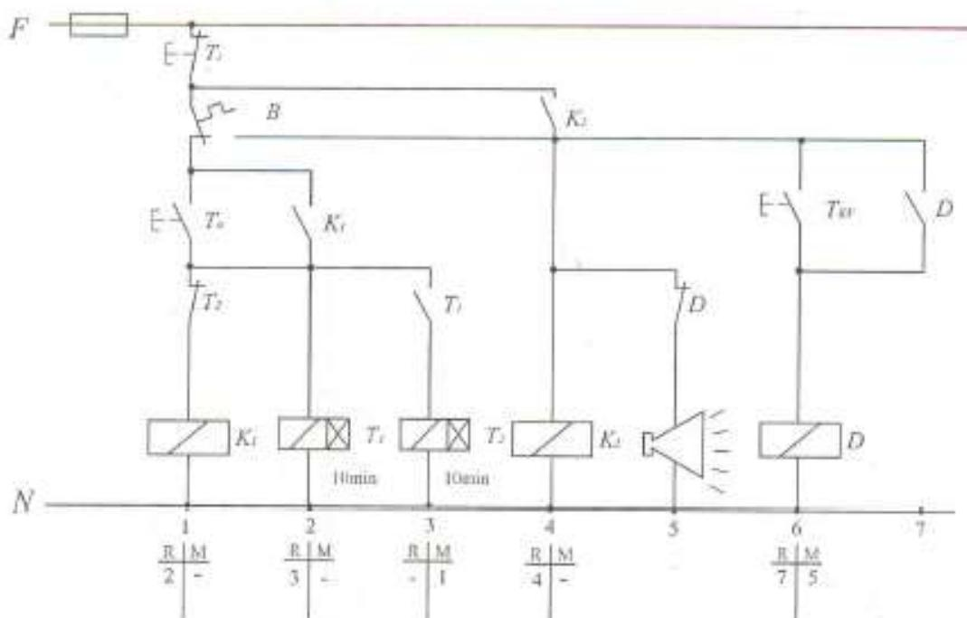
41. Pritiskom na taster za uključenje, motori  $M_1$  i  $M_2$  istovremeno počinju da rade, da bi se posle 5min. oba motora automatski isključili. Motori ostaju isključeni 15min., posle čega se automatski uključuje:
